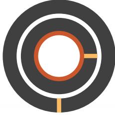
直管道保温错缝示意图（接缝错开90°）
