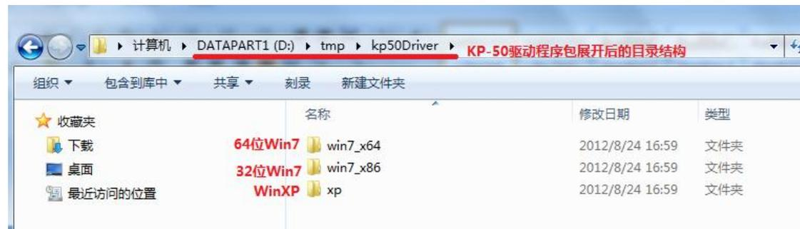
安装过程中，需根据 PC Windows 操作系统的类型选择对应的安装子目录。
